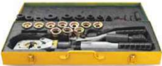
Опрессовка медного наконечника 16-300 мм 2 или алюминиевого наконечника 10-240 мм 2
