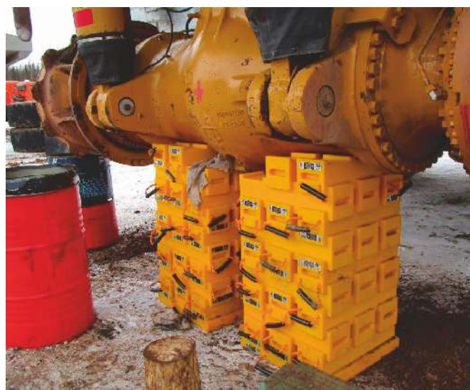
Модульные блоки в работе
